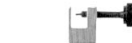
Инструмент для снятия стрелок в манометрах с электроконтактами, стандартное исполнение
