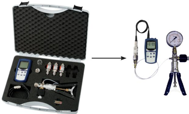
Grundausrüstung inkl. pneumatischer Druckerzeugung
