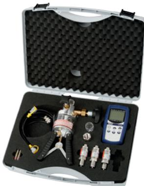
Grundausrüstung inkl. hydraulischer Druckerzeugung
