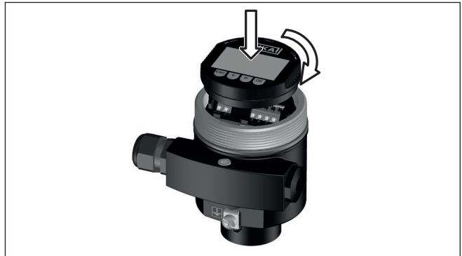
Рис. 25: Установка модуля индикации и настройки в отсеке электроники однокамерного корпуса
